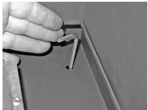
Abbildung 6: Einstellung der Höhe mit Sechskantschlüssel
