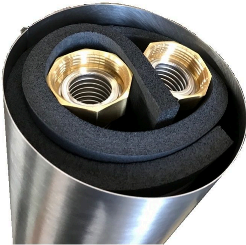
Abbildung 27: Wichtig: Dämmung erst zwischen VL und RL anbringen und dann beide Rohre außen umwickeln
